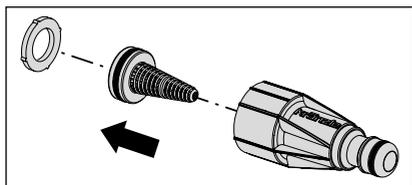
**7.1** Extraire le filtre s'il est encrassé et le nettoyer soigneusement à l'eau claire. Nettoyer les joints et la cage.
