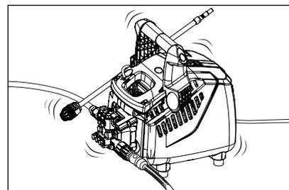
Après la fermeture du pistolet, le nettoyeur haute pression doit s'arrêter. Si ce n'est pas le cas, la cause peut être une fuite au niveau de la pompe, de l'interrupteur Start-Stop, du flexible haute pression, du pistolet ou de la lance.
