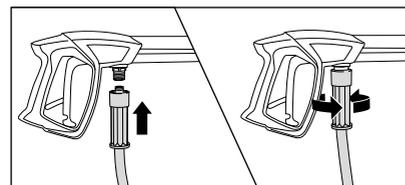
4. Visser fermement le flexible haute pression au Pistolet Marche/Arrêt de sécurité pour établir un raccordement étanche à la pression.
