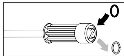
Arrêter l'appareil. Ouvrir brièvement le pistolet marche/arrêt de sécurité pour dépressuriser le système. Débrancher le flexible HP, le pistolet et la lance, puis contrôler l'état des joints d'étanchéité. Remplacer immédiatement les joints toriques s'ils sont défectueux.
