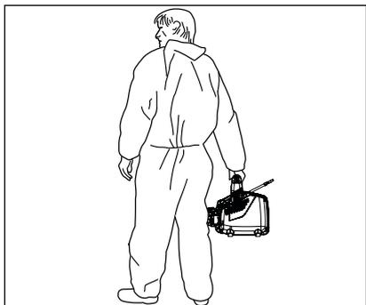
1. Porter le K 1050 P vers le lieu de mise en œuvre. Avant de déposer le nettoyeur haute pression, s'assurer que les quatre amortisseurs caoutchouc reposent bien au sol.
