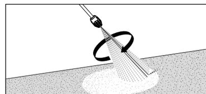
**11.** En cas d'utilisation de la buse Turbo-Jet, veiller à orienter la lance vers le bas avant d'activer le pistolet.
