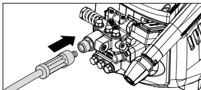
3. Raccorder à la sortie de pompe le flexible haute pression compris dans la livraison fermement et de manière étanche à la pression.
