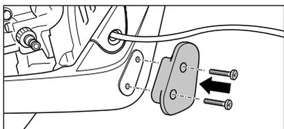
1. Fixer, à l'aide des vis fournies, l'arceau inférieur d'enroulement du cordon d'alimentation électrique contre le châssis à l'endroit prévu à cet effet.
