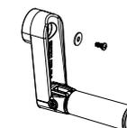
7. Manivelle avec vis de fixation
