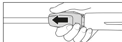
7. Après insertion de la lance dans le raccord, relâcher la douille et vérifier si la lance est bien enclenchée. **Graisser régulièrement le raccord baïonnette avec une graisse sans acide.**
