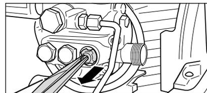
Nettoyer les soupapes avec un fil métallique (trombone) en les passant sous l'eau d'un robinet.
