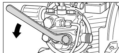
Retirer les vis avec corps de soupapes et joints toriques. S'assurer que les joints toriques ne sont pas endommagés et les échanger si nécessaire.
