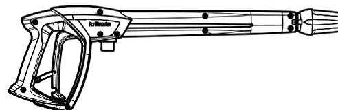
2. Pistolet à fermeture de sécurité avec raccord rapide
