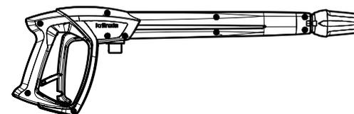
2. Pistolet à fermeture de sécurité avec raccord rapide
