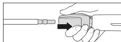
6. Tirer tout d'abord vers l'arrière la douille d'enclenchement du pistolet avant d'insérer la lance dans le raccord rapide.
