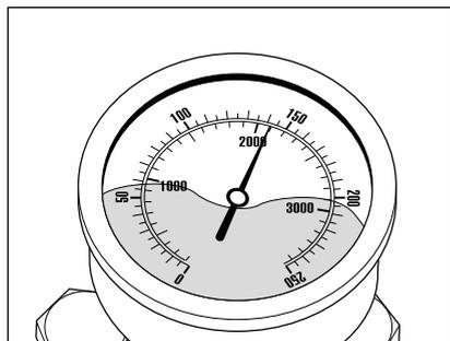
Après la fermeture Pistolet Marche/Arrêt de sécurité, le nettoyeurs haute pression doit s'arrêter et le manomètre avec boîtier inox doit alors indiquer „0“ bar. Si le nettoyeur ne s'arrête pas et que le manomètre avec boîtier inox continue à indiquer pleine pression, la cause peut être une fuite au niveau de la pompe haute pression, du pressostat, du flexible haute pression ou du Pistolet Marche/Arrêt de sécurité.
