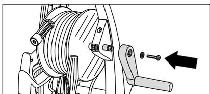
2. Sur les nettoyeurs haute pression avec tambour-enrouleur, la manivelle fournie doit être mise en place et fixée avant la première mise en service. A cet effet, mettre le nettoyeur haute pression en position verticale. Enficher la manivelle sur l'axe à six pans et la fixer en resserrant la vis fournie.
