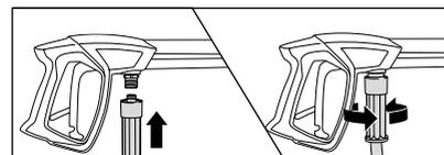
5. Brancher le raccord gris pivotant du flexible HP sur le pistolet Marche/Arrêt de sécurité, puis les visser fermement entre eux pour établir un raccordement étanche à la pression.
