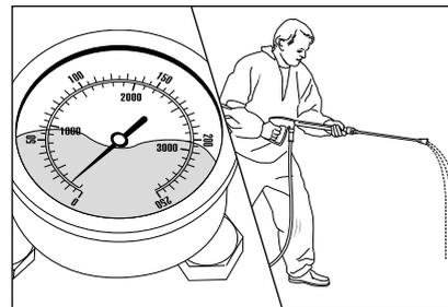
Bien que le régulateur de pression soit entièrement ouvert, la Le manomètre avec boîtier inox est très faible et un jet d'eau irrégulier sort de la lance. Le flexible haute pression vibre.
