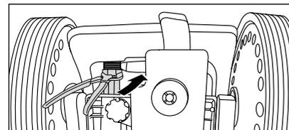
1. Découpler le tuyau reliant la pompe haute pression et le réservoir à eau.
