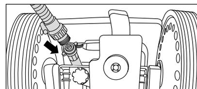
2. Relier le tuyau de prélèvement d'eau avec filtre d'aspiration (N° de réf. 150383) visser au moyen d'un raccord double (N° de réf. 46004) au tuyau de raccordement.
