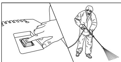
11. Mettre le nettoyeur haute pression en marche, le pistolet Marche/Arrêt de sécurité étant ouvert, puis chasser l'air du nettoyeur haute pression : A cet effet, ouvrir et fermer le pistolet à plusieurs reprises. Le nettoyeur haute pression est désormais prêt pour la réalisation des travaux de nettoyage.
