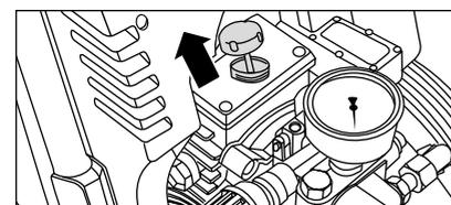
9. **Contrôler le niveau d'huile à l'aide de la jauge de niveau avant chaque mise en service.**
