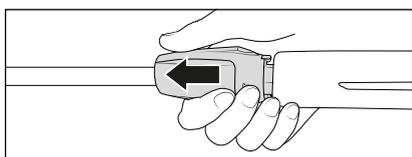
6. Après insertion de la lance dans le raccord, relâcher la douille et vérifier si la lance est bien enclenchée. **Graisser régulièrement le raccord baïonnette avec une graisse sans acide.**
