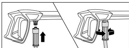
4. Brancher le raccord gris pivotant du flexible HP sur le pistolet Marche/Arrêt de sécurité, puis les visser fermement entre eux pour établir un raccordement étanche à la pression.
