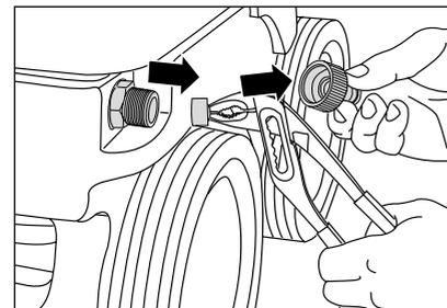
7. **Avant chaque mise en service, vérifier si le filtre d'entrée d'eau est propre.**
