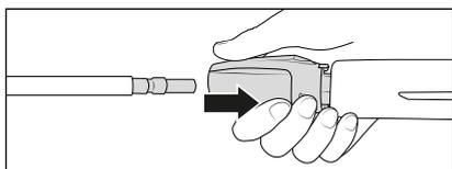
5. Tirer tout d'abord vers l'arrière la douille d'enclenchement du pistolet avant d'insérer la lance dans le raccord rapide.
