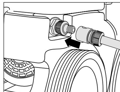
8. Raccorder le tuyau d'eau au manchon d'entrée d'eau (Exigences minimales: tuyau de 5 m de longueur, section de 3/4", 10 bars). Le nettoyeur peut être raccordé, au choix, à une conduite d'eau froide ou d'eau chaude de 60 °C max. (1 à 10 bars de pression d'alimentation). La série quadro de petite puissance permet le prélèvement d'eau d'alimentation depuis un fût (voir Aspiration directe).
