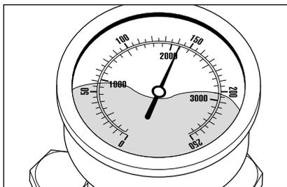
Après la fermeture Pistolet Marche/Arrêt de sécurité, le nettoyeurs haute pression doit s'arrêter et le manomètre avec boîtier inox doit alors indiquer „0“ bar. Si le nettoyeur ne s'arrête pas et que le manomètre avec boîtier inox continue à indiquer pleine pression, la cause peut être une fuite au niveau de la pompe haute pression, du pressostat, du flexible haute pression ou du Pistolet Marche/Arrêt de sécurité.
