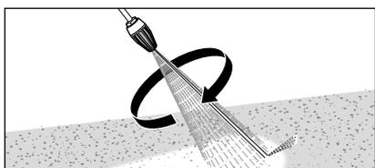
12. En cas d'utilisation de la buse Turbo-Jet, veiller à orienter la lance vers le bas avant d'activer le pistolet.
