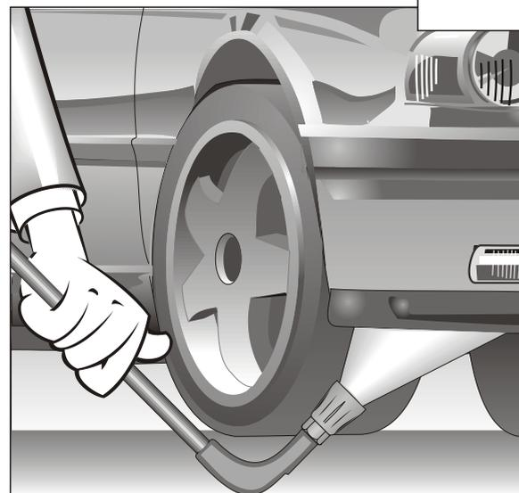
Lors de l'utilisation de la lance bas de caisse, celle-ci doit absolument être en contact avec le sol avant l'ouverture du pistolet. Pour les lances cintrées, telle que la lance N° 41.075, le coup de bélier produit un couple de rotation. (Voir tableau à la page 2)
