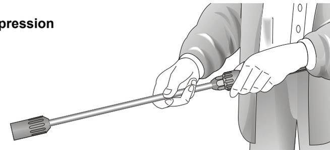
3. Dérouler le tuyau haute pression sans faire de boucles et le relier au pistolet et à la pompe. Rallonge max. de 20 m ou 2 tuyaux H.P. de 10 m avec raccords appropriés.
