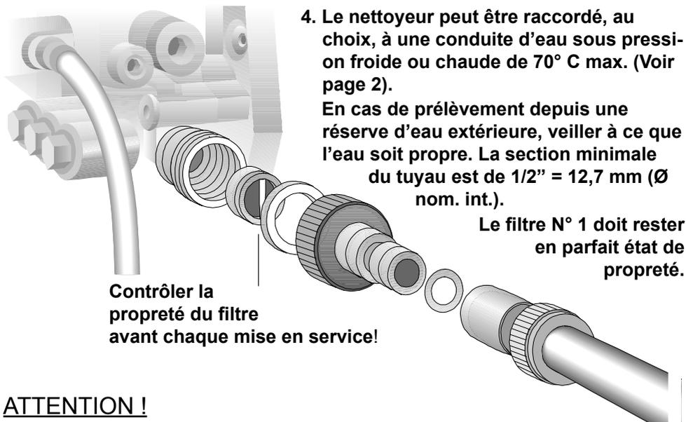
4. Le nettoyeur peut être raccordé, au choix, à une conduite d'eau sous pression froide ou chaude de 70° C max. (Voir page 2).
